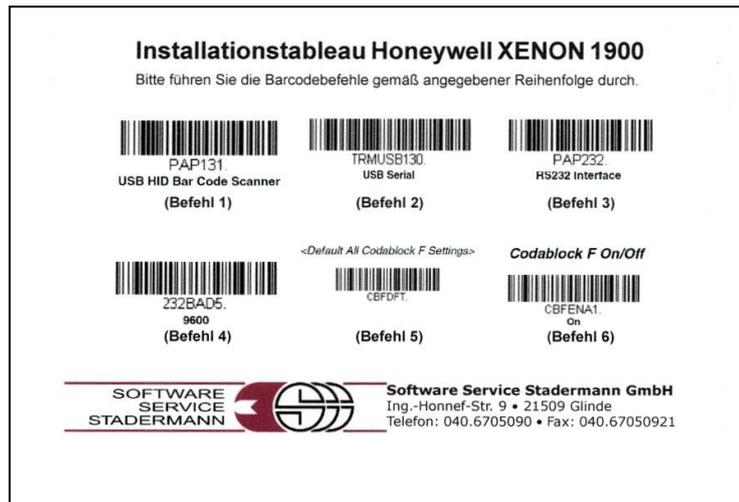
Scannen Sie alle Barcodes der Reihe nach von oben links nach unten rechts (Befehl 1 bis Befehl 6). Bei jedem Scan hören Sie einen Signalton. Danach ist der Programmiervorgang abgeschlossen.
